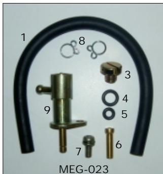
Diese universellen Power Jet Kits können an fast allen Vergasern nachgerüstet werden. Der Düsenhalter wird hinten am Vergasergehäuse angebracht und die Schwimmerkammer wird angebohrt um den Schlauchanschluss aufnehmen zu können.
